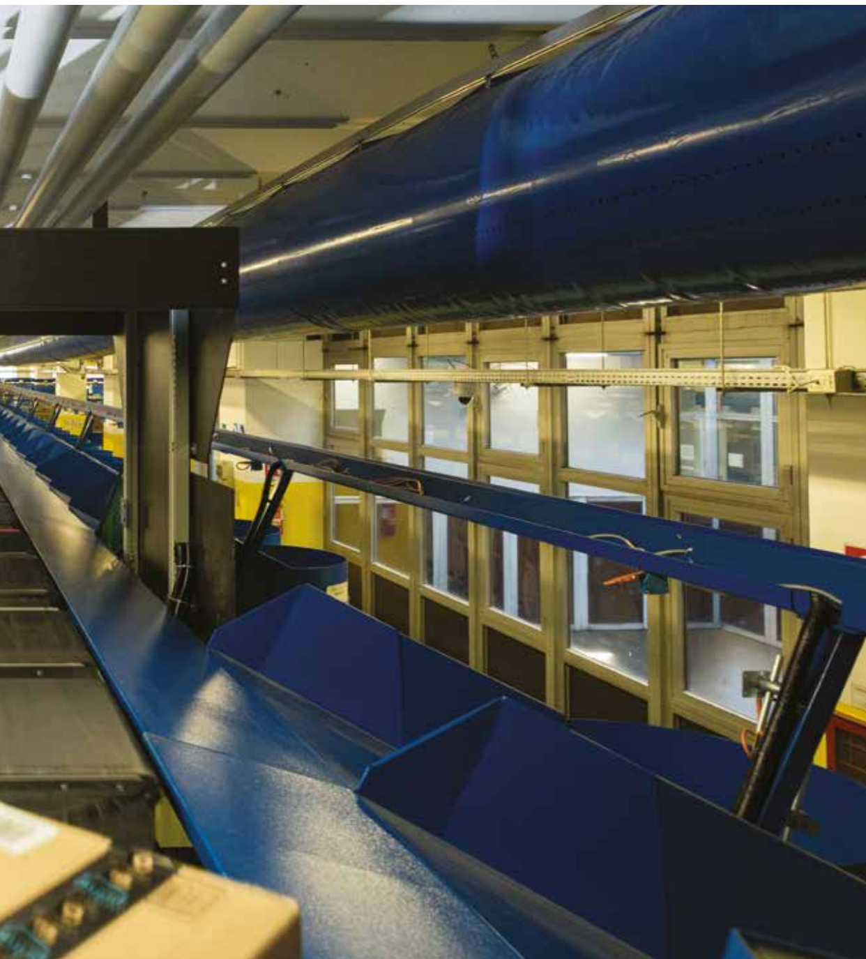
Alcuni momenti dei processi di lavorazione al Centro di Meccanizzazione di Roserio. Nella foto grande il Sorter che è in grado di lavorare circa 60 milioni di pezzi all'anno
